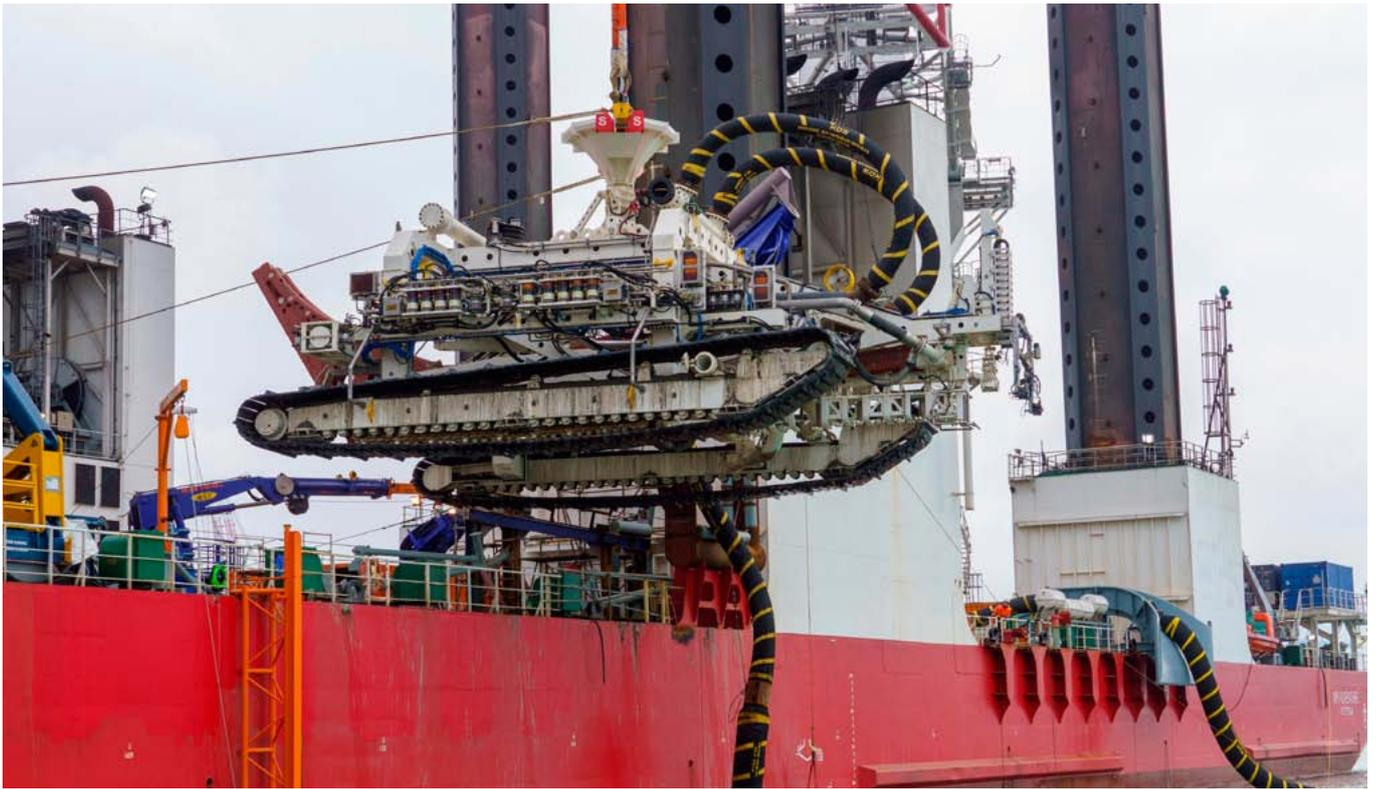
**FIGURE 3-7.** A SPECIAL DEVICE *DEEP DIG-IT*, WHICH SINKS THE CABLE TO THE SEABED, IS LAUNCHED FROM THE SHIP'S BOARD.
